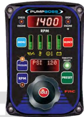
El gobernador detecta la pérdida de agua en la columna como resultado de falta de agua en esta o la pérdida de vacío, disminuyendo automáticamente las revoluciones y buscando nuevamente compensar el sistema hasta que logra recuperar la columna con el apoyo del cebador automático y regresa a operación normal.
