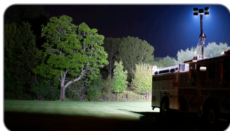
Se extiende 2 metros sobre el vehículo de servicio de emergencia
